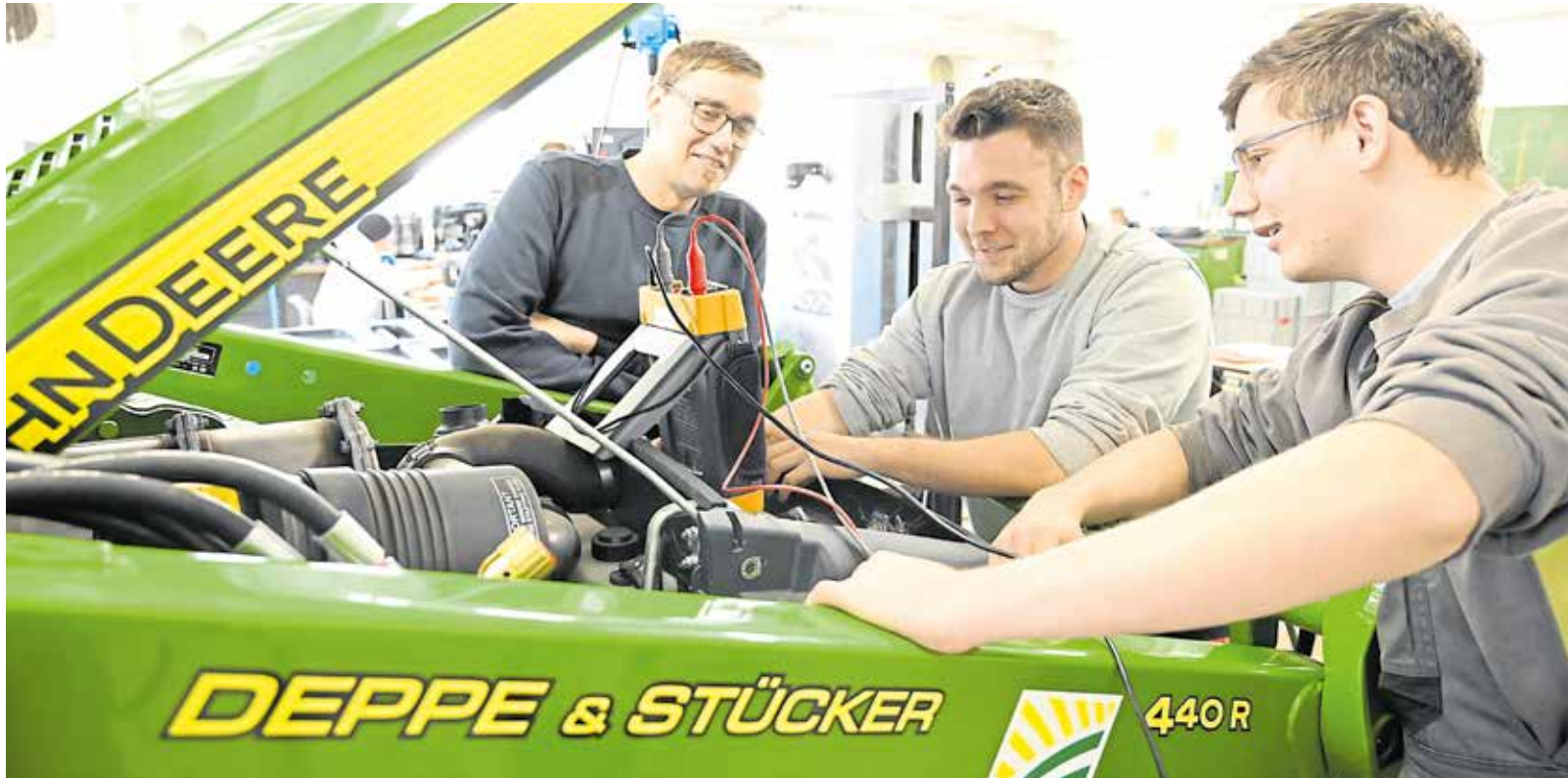
Ausbilder Sven Wangemann (links) mit den LBM-Auszubildenden Kim Heidemann (Mitte) und Ivo Wernicke (rechts) bei der Fehlersuche am John Deere 4R Kompakttraktor im Lehrgang zu Datenübertragungssystemen in Land- und Baumaschinen.
