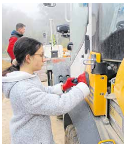
Die Sicherungen eines Radladers mussten geprüft werden.
