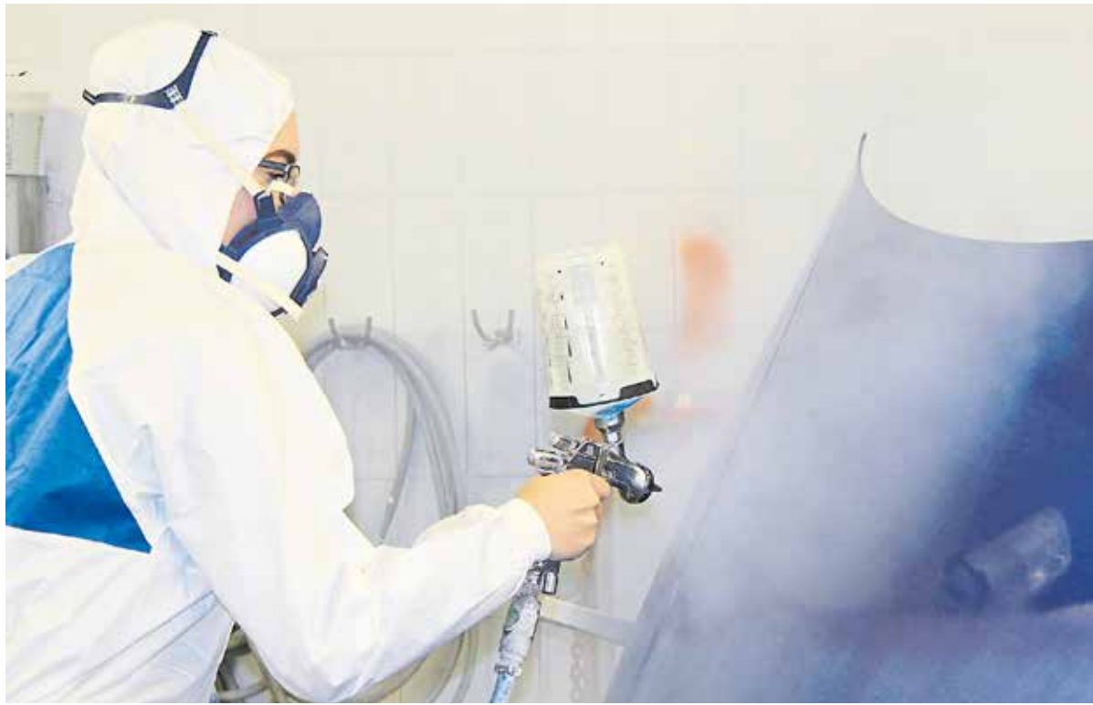
Im Lackieranzug und mit Atemschutzmaske trägt Jenny Koch mit einer Spritzpistole Klarlack auf eine Motorhaube auf. Die Gesellin lebt und liebt ihr Handwerk und hat ihre Ausbildung mit besonders guten Noten absolviert.
