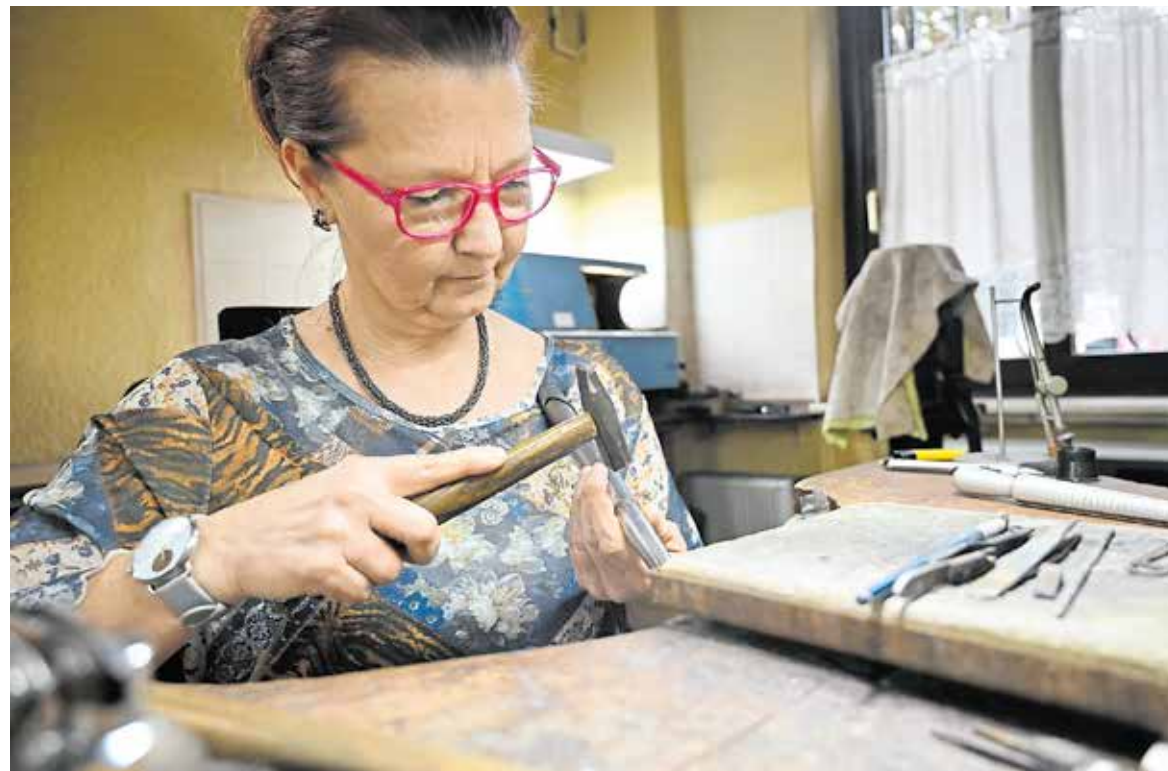
Goldschmiedemeisterin Yvonne Gottschalk bei der Vergrößerung eines Ringes. Dazu wird dieser auf einen Ringriegel aufgesteckt und mit dem Hammer bearbeitet. Foto: HWK Halle/Nicole Scheermann
