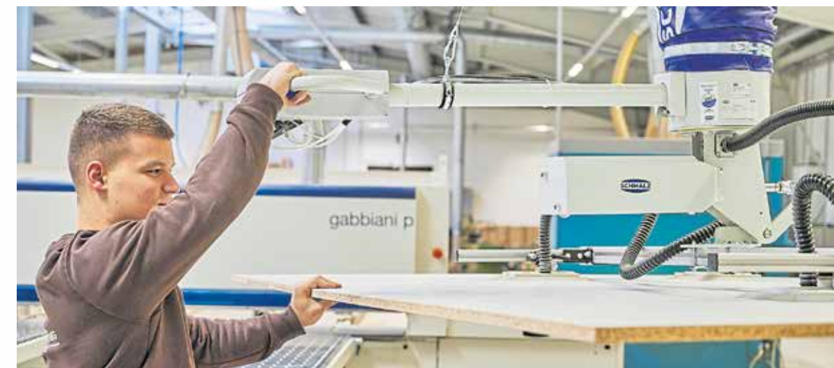
Mithilfe eines Saugarms platziert Yan-Oliver Wellbrock eine Werkstoffplatte auf einer Maschine.
