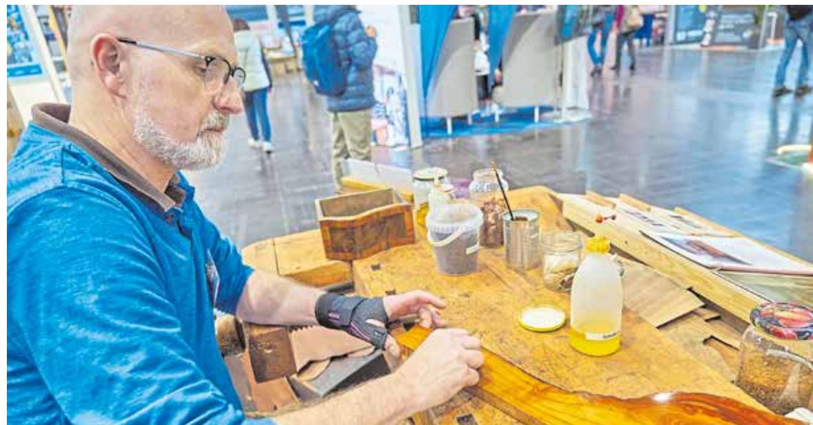
An einem Stück Kirschholz zeigte Tischlermeister und Restaurator Peter Hohmann, wie Schellack in mehreren Schichten aufgetragen wird - eine traditionelle Oberflächenbehandlung wie zu Barockzeiten.
