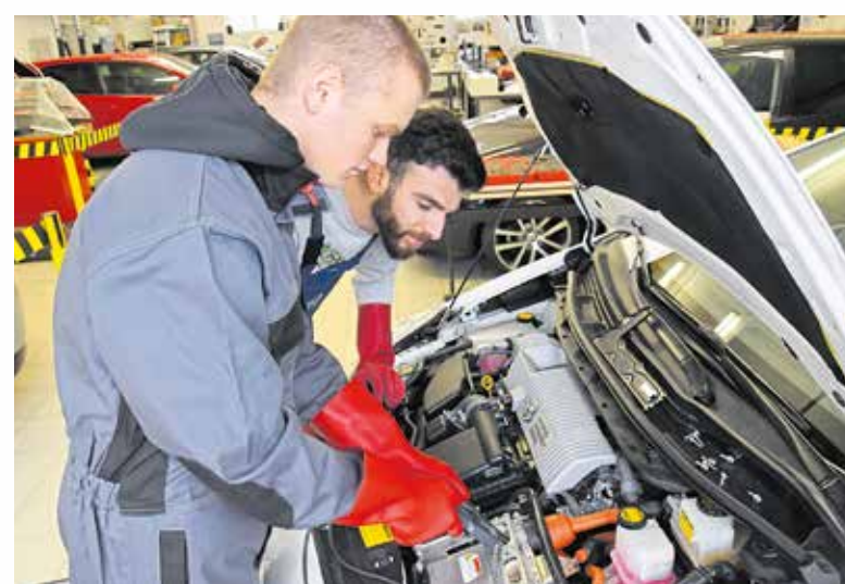
Wie man ein Hybridfahrzeug spannungsfrei schaltet, lernen die angehenden Kfz-Mechatroniker in ihrer ÜLU (überbetrieblichen Lehrunterweisung) zur Hochvolttechnik. Foto: HWK Halle/Tobias Kirchner
